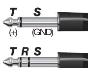
I cavi per chitarra "mono" standard schermati TS (Tip/Sleeve) possono sicuramente essere utilizzati, anche se l'utilizzo di cavi TRS "stereo" potrebbe migliorare il rapporto segnale/rumore e/o ridurre il ronzio, in particolare quando è necessario servirsi di cavi più lunghi.
